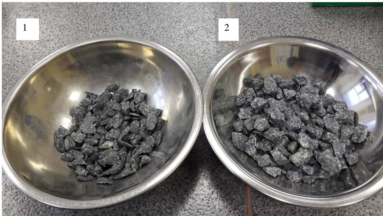
Рисунок 4 – Внешний вид щебня фракции 10-20 мм из габбро-диабазы, полученного с использованием дробилок ДЩ 100×200 (1) и 2ЩДС 100×200 (2)
